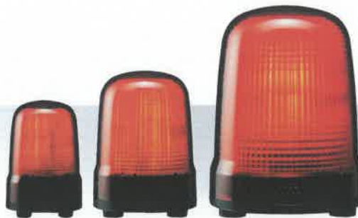
SL08: φ80mm SL10: φ100mm SL15: φ150mm ●옵션인 마운트 러버를 사용하여 IP 등급을 IP23에서 IP65로 높일 수 있습니다. (SL08, SL10에만 해당)
